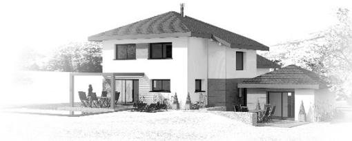
*Les caractéristiques principales de cette réalisation exemplaire tant du point de vue architectural que du point de vue bioclimatique : d'une surface de 148m<sup>2</sup>, plus 89m<sup>2</sup> d'annexes, cette maison orientée plein sud double isolation et d'une pompe à chaleur de 3<sup>ème</sup> génération.*
